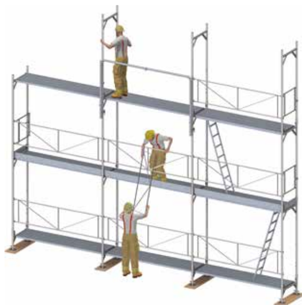
Figura 15: Montaggio del piano del ponteggio nella campata superiore con la protezione del parapetto di protezione (MSG).
