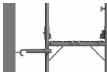
Figura 23: Tubo di ancoraggio, configurazione di base.
