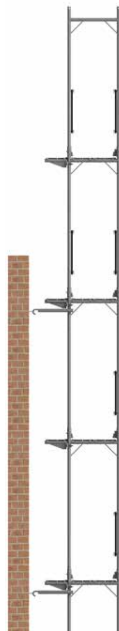
Figura 43: Piano del ponteggio libero come fase intermedia durante la costruzione di edifici.
