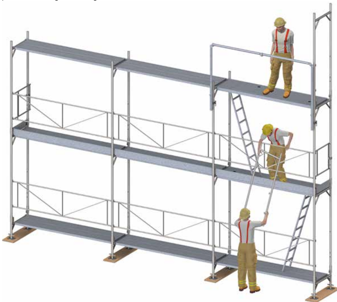
Figura 13: Esempio per la presa in consegna del materiale e il montaggio del ponteggio sull'ultimo piano del ponteggio.
