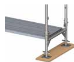
Figura 17: Installare la spina di sicurezza.
