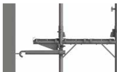
Figura 24: Tubo di ancoraggio, configurazione con mensola interna.
